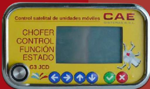
Con este dispositivo se realiza la **Verificación Esencial de Seguridad en Vehículo**, en el cual se hace un checklist electrónico. Cada operador que va a manejar el vehículo, tiene que realizarlo obligatoriamente antes de poder utilizarlo.
